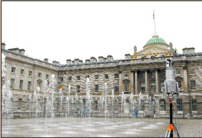
Il laser scanner Riegl LMS Z-390i montato e pronto per il rilievo.
