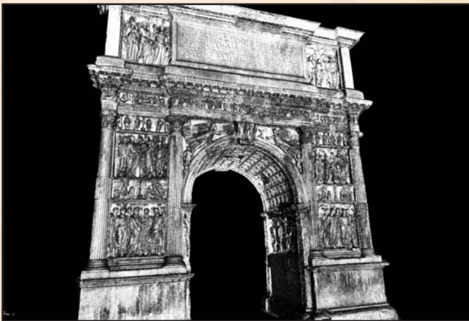
Dalla nuvola di punti alle superfici, MESH ad alta definizione di un elemento architettonico.
